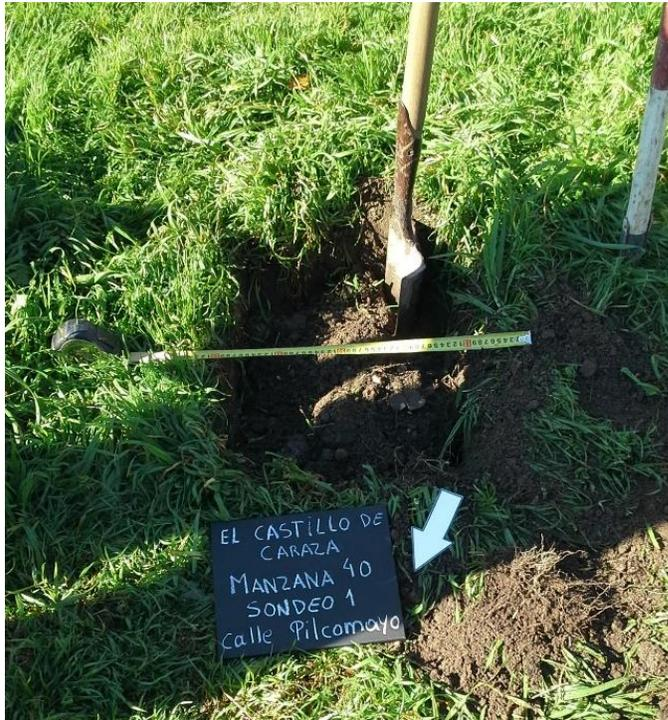
Figura N° 40: Fotografía del sondeo realizado sobre acera de la propiedad N° 5 en la manzana N° 40 sobre calle Pilcomayo. Fuente: Elaboración propia.
